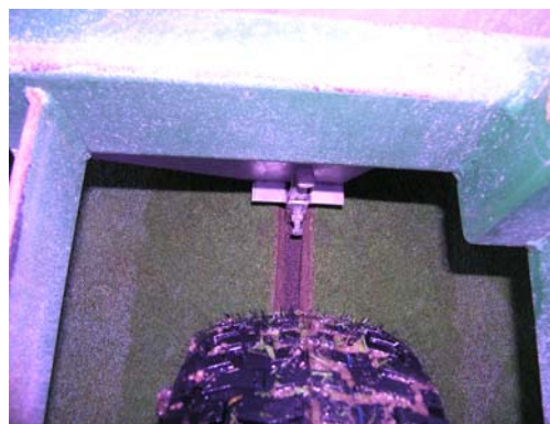
Figur 2. Slitsen bredd 2,5 cm och 20 cm djup med lecakulor (2-6 mm).
