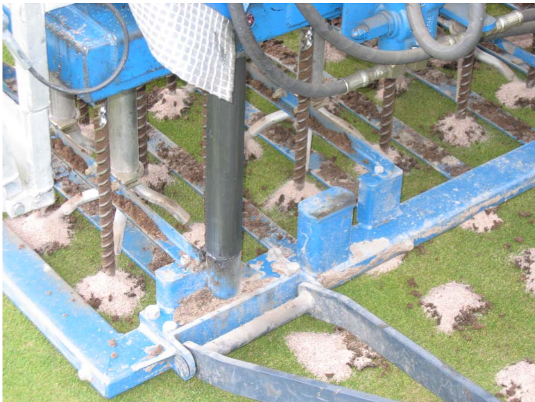
Sanden skall vara torr så att den kan rinna ner i de borrarade hålet
